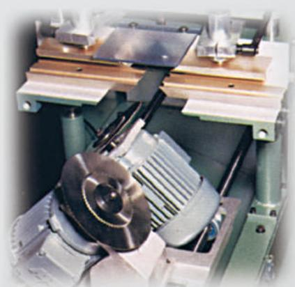
Specijalne kružne testere za podsecanje PVC lajsni
